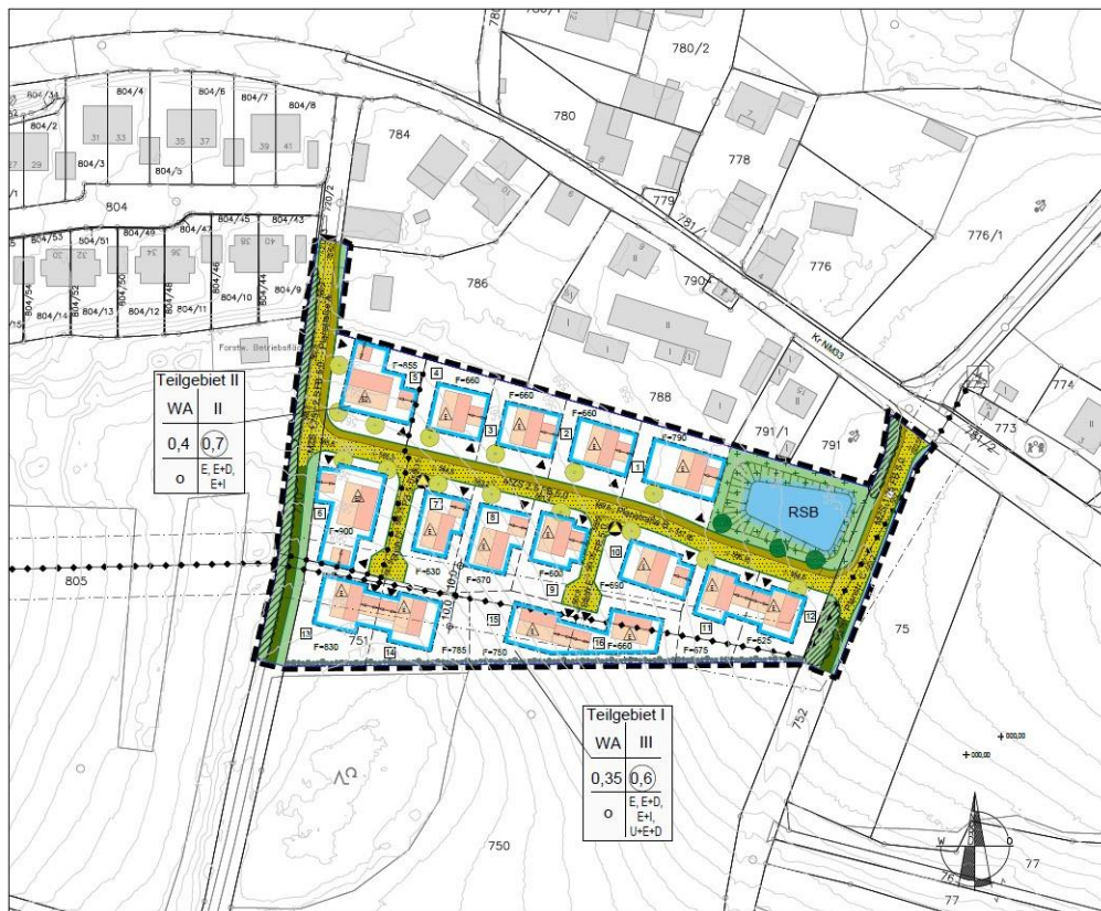
Bebauungsplan „“ mit integriertem Grünordnungsplan, Entwurf o.M., Stand: 06.06.2024; Quelle: IB Wöhrmann Hagelstadt / FLU Planungsteam
